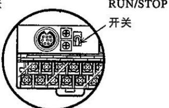
(b) 采用通用输入进行RUN/STOP；利用参数设定，可以把通用输入作为RUN输入使用（右图）。
